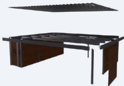
Die Dachdeckung besteht aus speziellem Trapezblech (T-35) mit Anthrazitbeschichtung (RAL 7016). Die Dachkonstruktion ist aus Profilstahl (100x100x2 mm) an der Vorder- und Seitenseite mit Rahmen geschweißt, was hohe Stabilität und Langlebigkeit gewährleistet.
