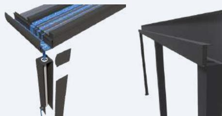
Die Rückseite ist mit einem Profil (250 x 100 x 100 mm) und einer zusätzlichen Verstärkung (20 x 100 x 2 mm) ausgestattet. Das Wasser vom Dach wird durch ein in den Pfosten eingebautes Kunststoffrohr abgeleitet, das den Anschluss an die Kanalisation ermöglicht.
